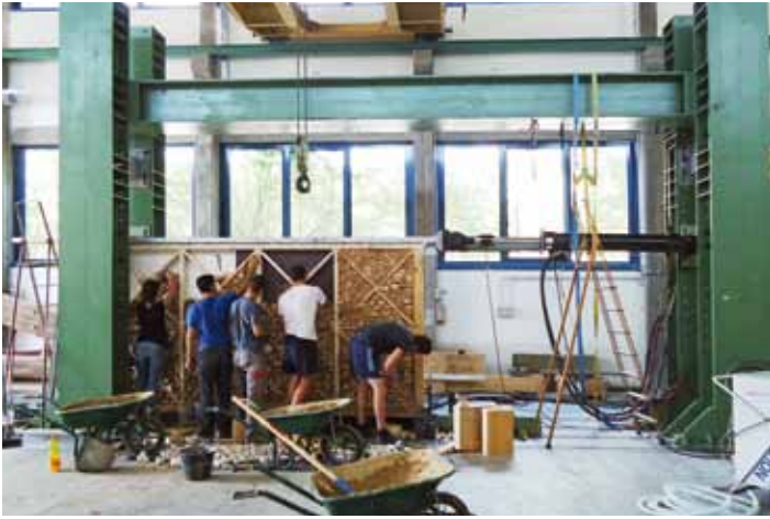
Des essais ont été réalisés à plusieurs échelles et avec différents remplissages (à gauche en pierres maçonnées à la terre, à droite en adobes) à l'aide de deux murs à réaction.
